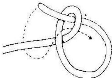
Il est simple, solide et sûr. Plus la charge est lourde, plus il se resserre. On peut l'utiliser en escalade (pour s'asseoir et descendre ou remonter quelqu'un le long d'une paroi à pic), dans des opérations de sauvetage, ou tout simplement au bout de la ficelle enroulant un paquet.
